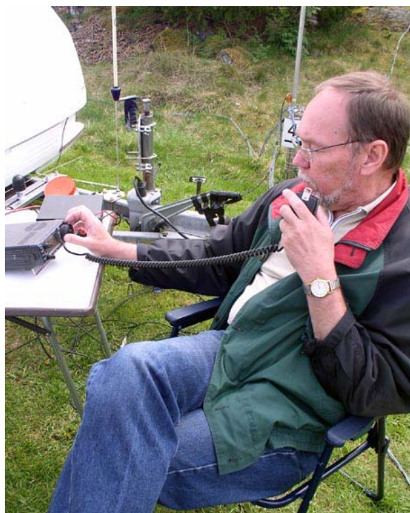
Janne/SM5TJH kollar uteffekt och SWR på ICOM-706 på olika banden och kör sedan QSO på 14 MHz
