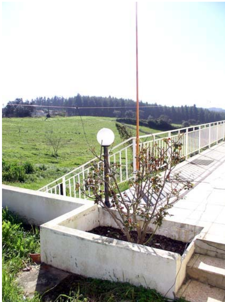
Jannes lättviktiga vertikalantenn monterad mot ett altanräcke. G5RV'n i bakgrunden
