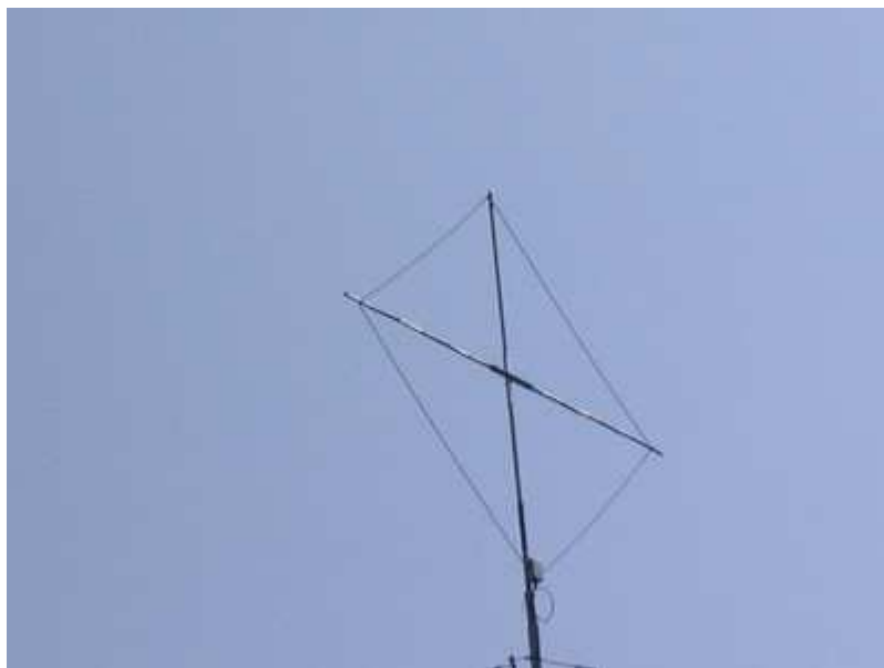
Det här är en antennen som Taki använder på sitt QTH i Botswanas huvudstad Gaborone. Vi gissar att det är en single element quad för 15 eller 10m.
